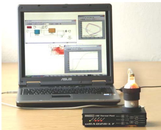
Školská tepelno-optická sústava: zostava s počítačom a detail
